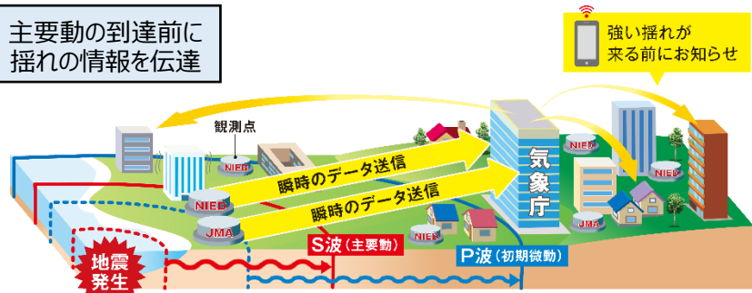
緊急地震速報の仕組み
