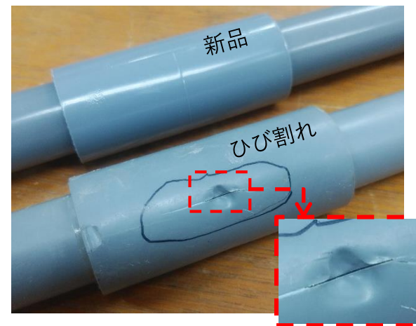
継手のひび割れの例
