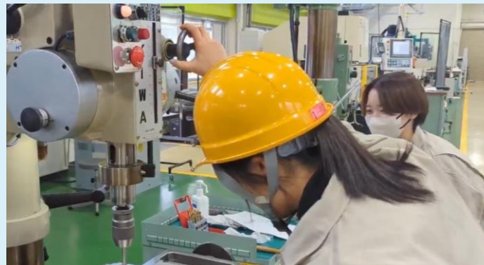
ボール盤による穴あけ作業
