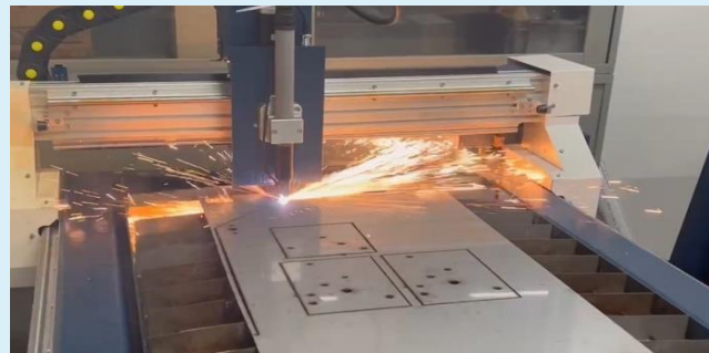
プラズマによる切削作業
