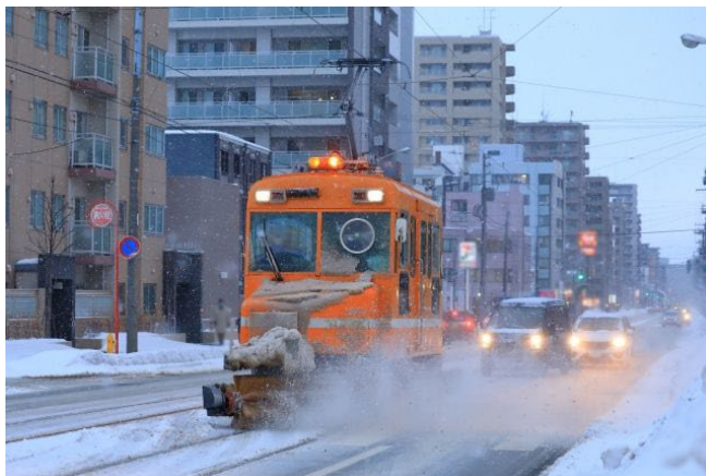
図2 左の写真は札幌（さっぽろ）市電のササラ電車です。このように真冬（まふゆ）の北海道（ほっかいどう）の雪は水分が少ないので軽く、は掃（は）くだけで除雪（じょせつ）できます。一方、右の写真のように水分の多い新潟（にいがた）の雪はかたまった雪を除雪機械（じょせつきかい）でけずります。
