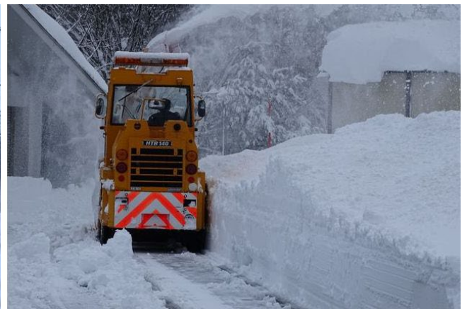
図2 左の写真は札幌（さっぽろ）市電のササラ電車です。このように真冬（まふゆ）の北海道（ほっかいどう）の雪は水分が少ないので軽く、は掃（は）くだけで除雪（じょせつ）できます。一方、右の写真のように水分の多い新潟（にいがた）の雪はかたまった雪を除雪機械（じょせつきかい）でけずります。
