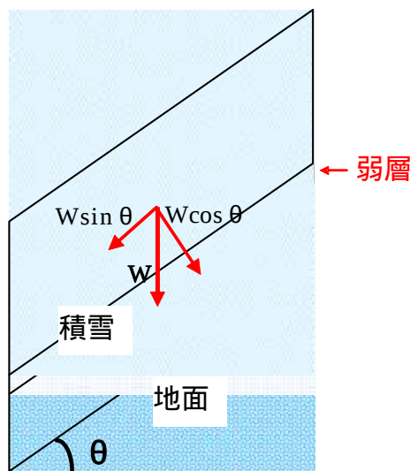
図 3 表層雪崩発生の様式図
