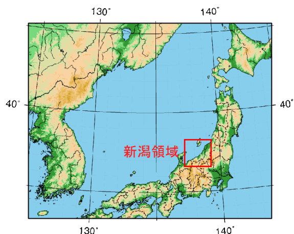
図2：気象モデルの計算領域。外側が10km解像度(グリッド166x134x38)、内側が1.2km解像度(グリッド152x152x38)で計算を行う。
