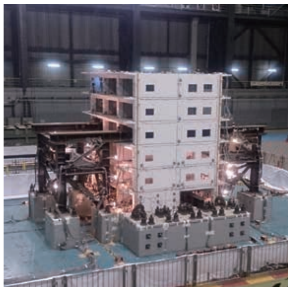
写真1 RC造6層建物の30%縮小試験体
