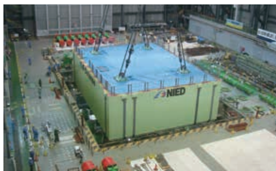
写真2 三次元継手など部品交換のため震動台を外す
