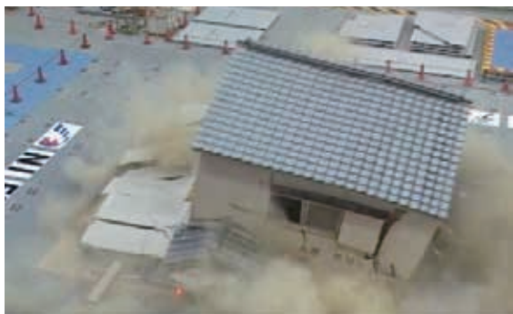
写真1 木造建物が倒壊した様子
