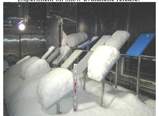
着雪や雪の付着特性に関する実験 Experiment on accretion and adhesion of snow.
