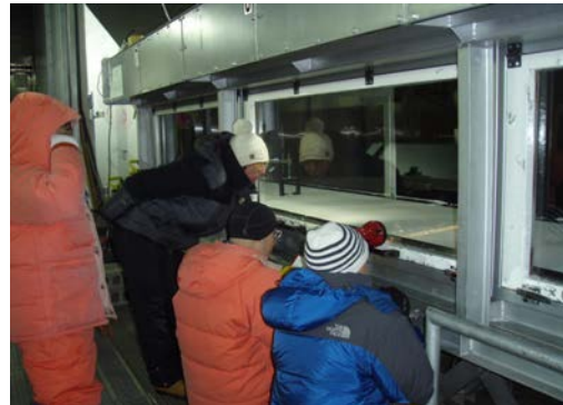
吹雪の鉛直分布に関する風洞実験 (フランスとの共同研究) Wind-tunnel experiment on vertical profiles of drifting snow. (Cooperative research with France)
