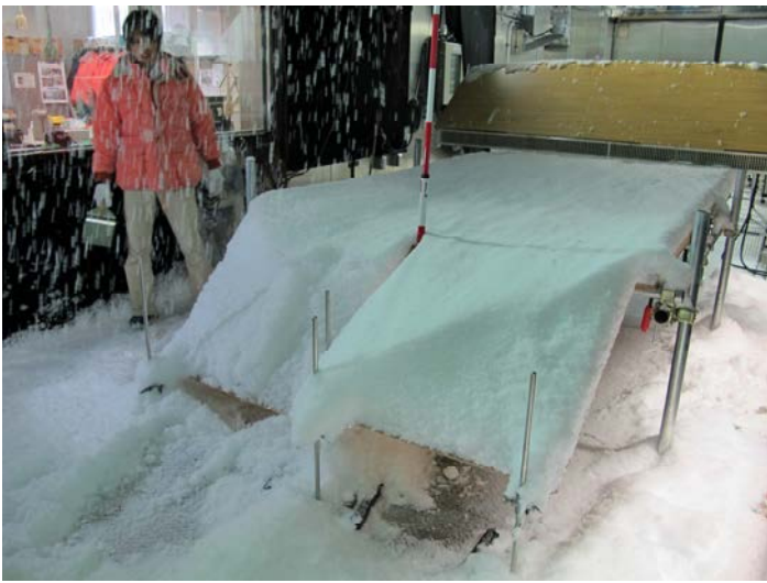
雪庇の形成条件に関する実験 Experiment on snow cornice formation.
