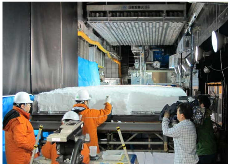
降雨による屋根雪荷重増加の実験 Experiment on the impacts of rain on snow load on a roof.
