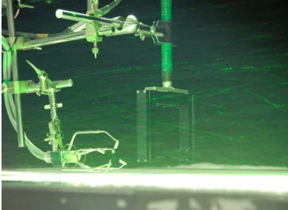
吹雪の内部構造や発達過程を調べるための風洞実験
