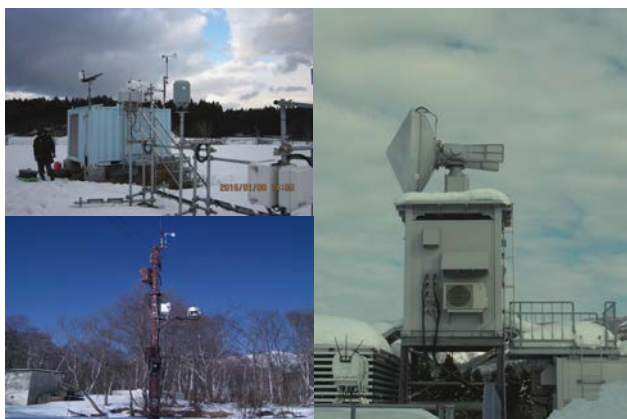
多相降水レーダー（右）とその視野内に設置された降雪粒子観測線の柏崎サイト（左上）、標高1310mに設置された積雪・気象観測ネットワークの妙高笹ヶ峰観測点（左下）
