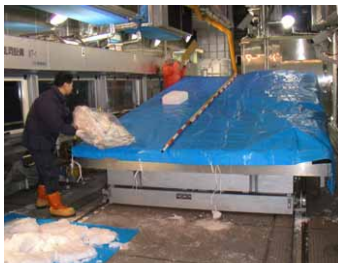
図4 雪氷防災実験棟におけるブルーシート上での雪ブロックの滑走実験
