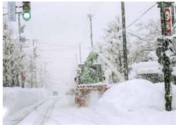
市道除雪中のロータリー車
