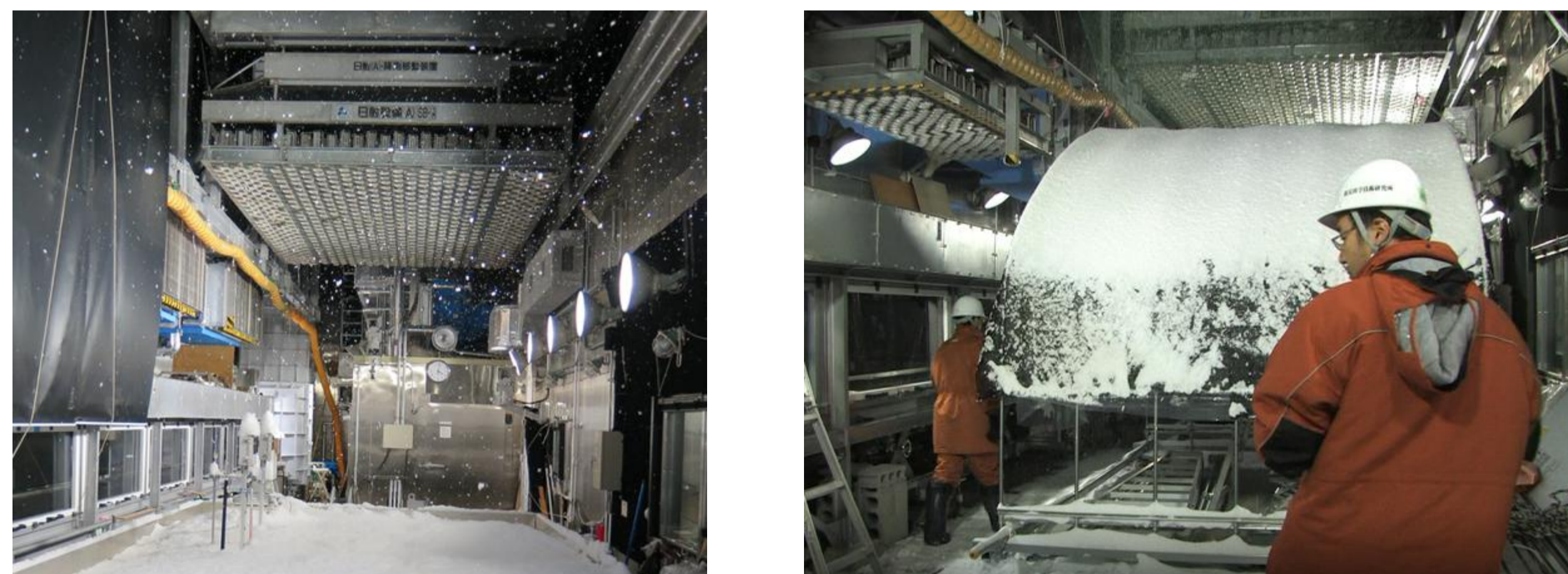
新型降雪・積雪センサーの開発 ビニールハウスの積雪耐荷重試験
