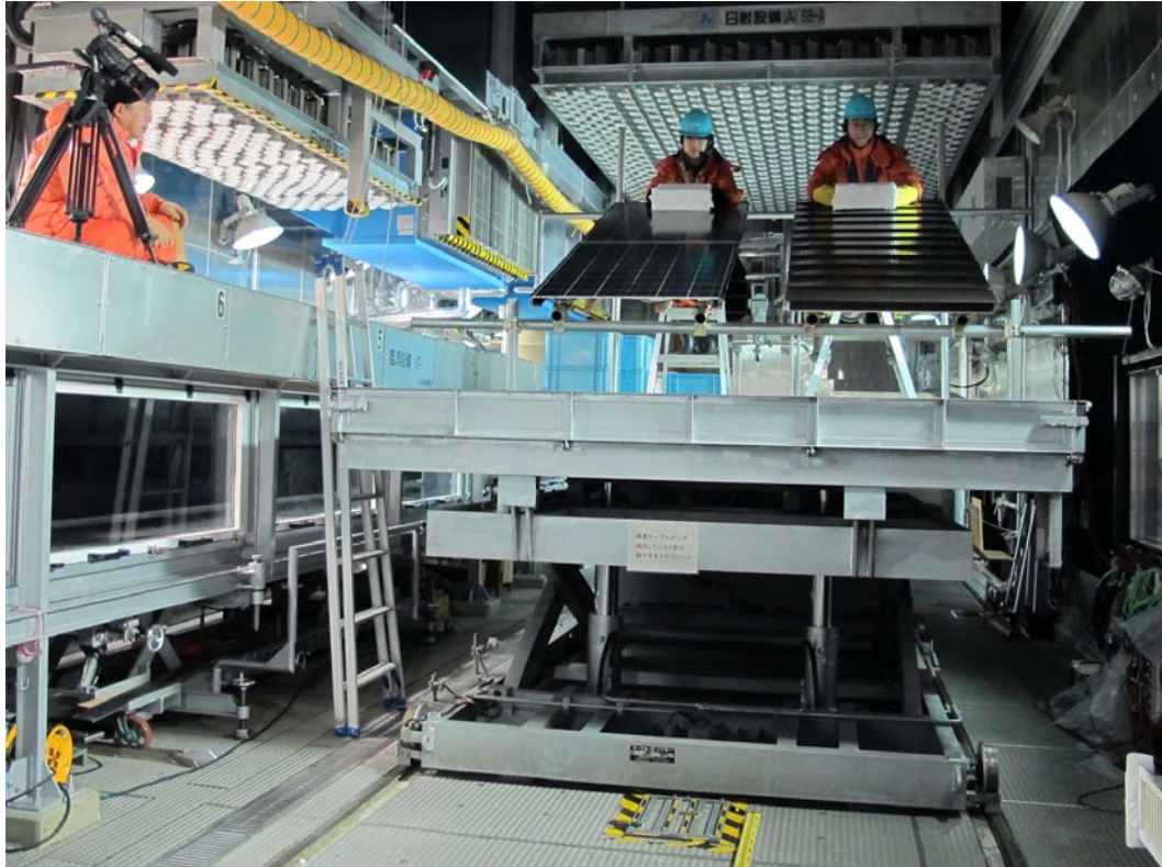
写真1 太陽電池パネルとトタン屋根の雪の同時滑走実験
