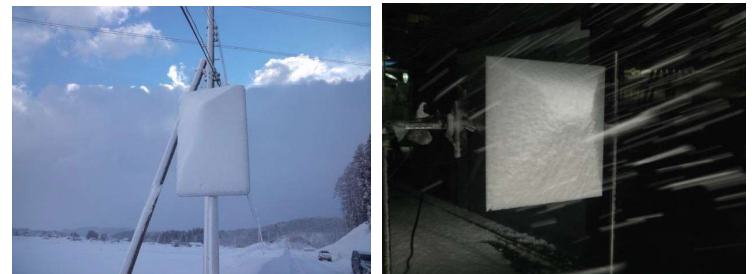
図2 道路標識の着雪状況の再現
