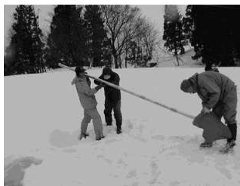
図5(続き) (b) スノーサンプラーによる積雪水当量の測定。
