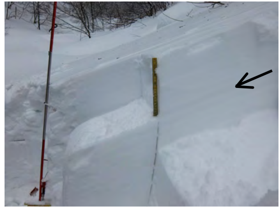
図4 破壊テストで現れたすべり面 (矢印)
