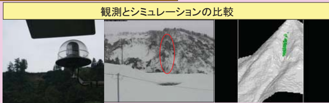
監視カメラ 観測された雪崩 雪崩の計算
