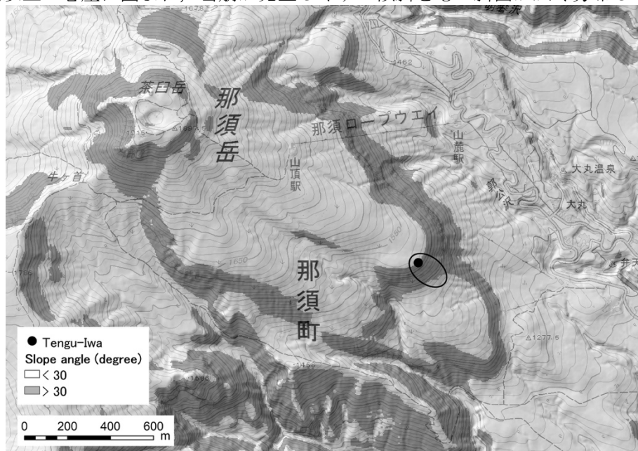
図 1 茶臼岳周辺の地形概略図（背景は地理院地図。黒丸は天狗岩、円内は雪崩が生じた斜面）
