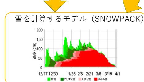
積雪変質モデル「SNOWPACK」を使って、気象データから雪が積もる量や融ける量、重さの変化を計算。これにより、積雪重量 ( $1\text{m}^2$ あたりの雪の重さ) が計算される。
