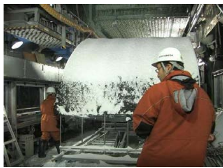
ビニルハウスの積雪耐荷重試験
