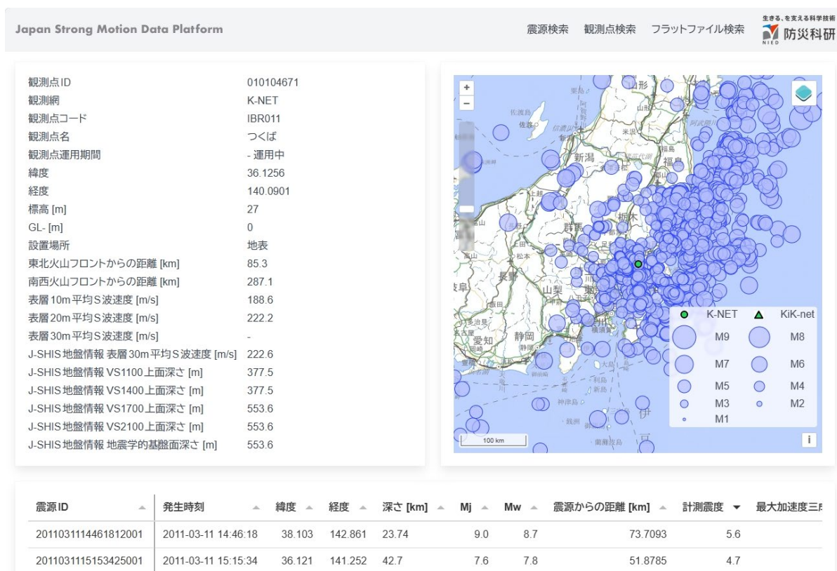
図5. 観測点詳細画面:観測点情報、地盤情報、およびその観測点で得られている強震観測記録一覧を表示できる
