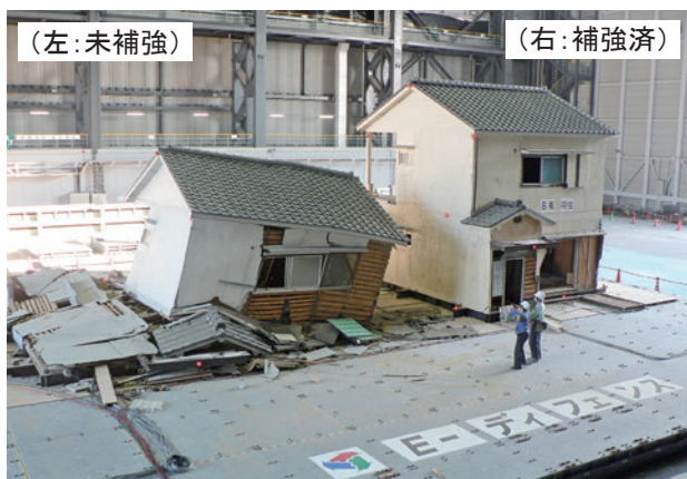
図5 木造住宅の補強効果の検証実験（2005年）
