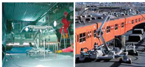
図3 電車用パンタグラフへの着雪再現試験(左)と実際の整備例(右)
