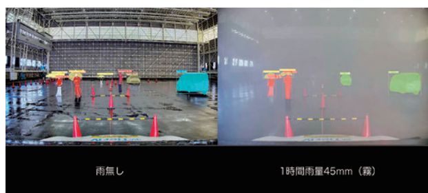
図2 大型降雨実験施設内での実験 上：豪雨下のドローン飛行実験、下：自動運転時のカメラとLiDARセンサーによる豪雨時の対象物の検知検証実験
