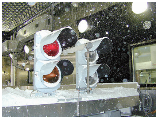
図4 信号機への着雪再現試験
